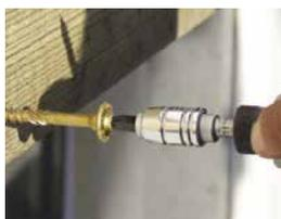
La tête de vis avec écran intégré (tête de vis à rondelle) n'a aucun rebord tranchant comme les tirefonds traditionnels. L'épaulement supplémentaire (diamètre nominal) sous la rondelle permet de centrer la vis RSS™ dans la quincaillerie déjà percée comme des charnières et des plaques de connexion.
